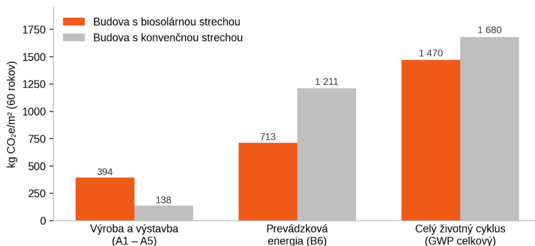
Obrázok 6 Porovnanie uhlíkovej stopy budovy s biosolárnou a konvenčnou strechou
